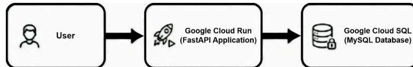
Gambar 3. Arsitektur Deployment pada Google Cloud Platform
